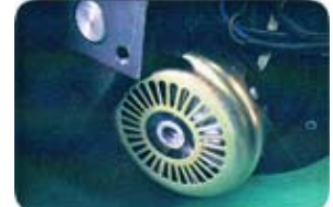
Motor Cooling Fan
